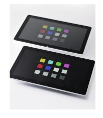
【 奥 】空気層を持つ従来の液晶ディスプレイ。 【手前】当社の光学接合用樹脂付カバーガラス を貼り合せた液晶ディスプレイ。 従来よりも表示コントラストが高く、 より鮮やかな色を表現。
