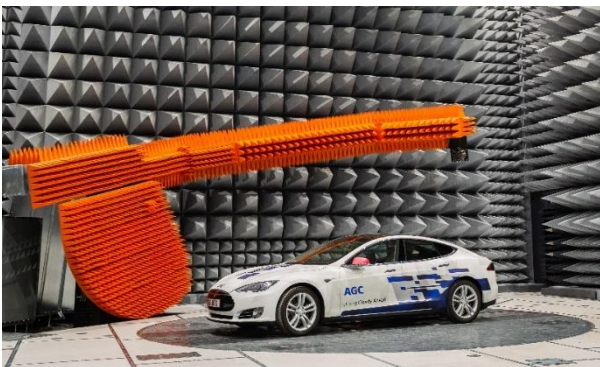
画像：今回竣工した欧州の電波暗室
