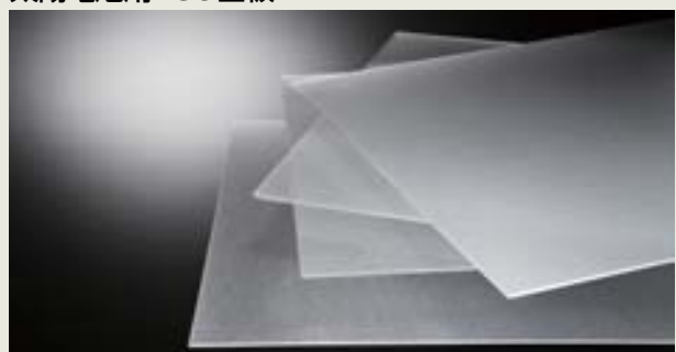
独自の表面形状で入射光を散乱させて、シリコン層内に光を閉じ込める、薄膜太陽電池用TCO基板
