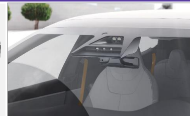
Glazing一体型LiDAR フロントガラス等グレーディング一体型の LiDAR保護
