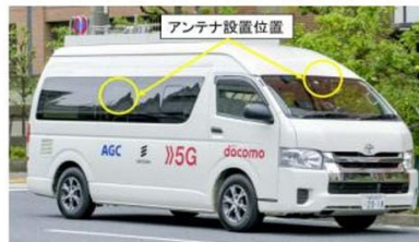
NTTドコモ、エリクソンと共同で「ガラス一体型5Gアンテナ」による5G通信に成功
