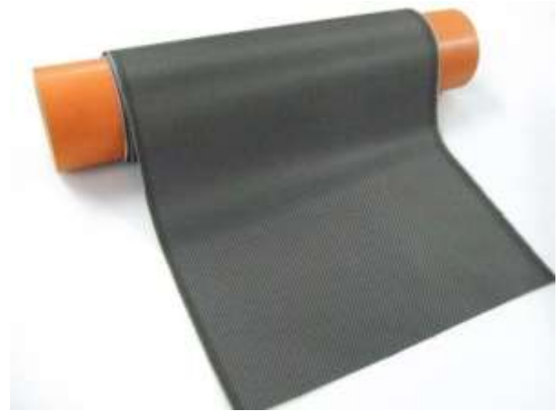
フッ素樹脂改質後の CFRTP
