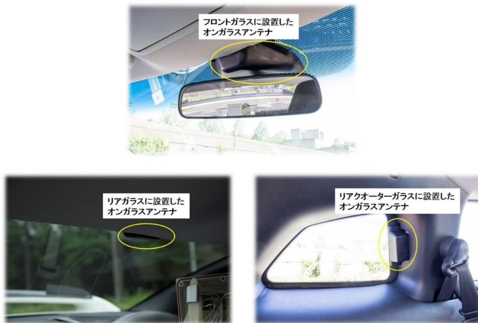
図3 オンガラスアンテナの設置模様
