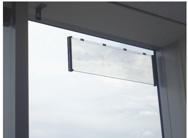
ガラスアンテナを既存窓に貼付した様子（画像）
