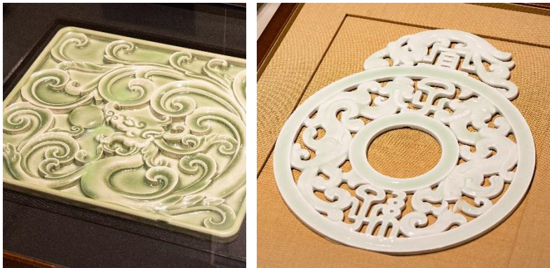
バインダージェット方式 3D プリンターを用いた陶板
