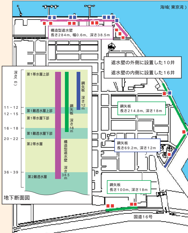
上: 遮水壁や揚水施設を設置した範囲。帯水層とは砂層など水を通しやすい地層。通常、地下水はここに存在する。難透水層は粘土層など水を通しにくい地層 左: 汚染水の揚水施設。くみ上げられた地下水は水蒸気蒸留によって浄化される
