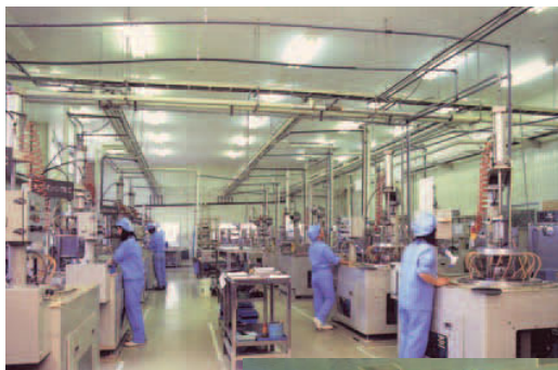
光学・電子部品は高密度・大容量の高性能化が進んでおり、電子デバイス用ガラス部品には精密な加工精度が求められる。左上は電子デバイス用ガラス部品の研磨工程、右下は同クリンルームでの検査工程
