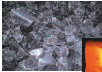
カレット状になって運び込まれてきたガラス。これを窯に投入し、ブラウン管用ガラスの原料として再利用する
