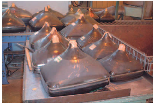
回収された廃テレビバルブ。この後、中間処理業者で砕かれてカレット状のガラスになる
