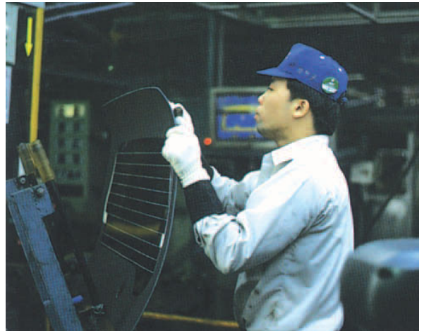
自動車用ガラスの製造はほとんど機械化されているが、傷など、重要な部分のチェックはやはり人の目が一番信頼できる
