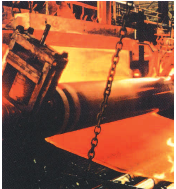
2枚の真っ赤な板状ガラスの中に網を挟み込んで、建築用網ガラスをつくる。溶かすときには1500以上の熱を加えるが、このときガラスの温度は900に保たれる
