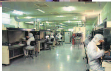
光学・電子部品は高密度・大容量の高性能化が進んでおり、電子デバイス用ガラス部品には精密な加工精度が求められる。左上は電子デバイス用ガラス部品の研磨工程、右下は同クリンルームでの検査工程
