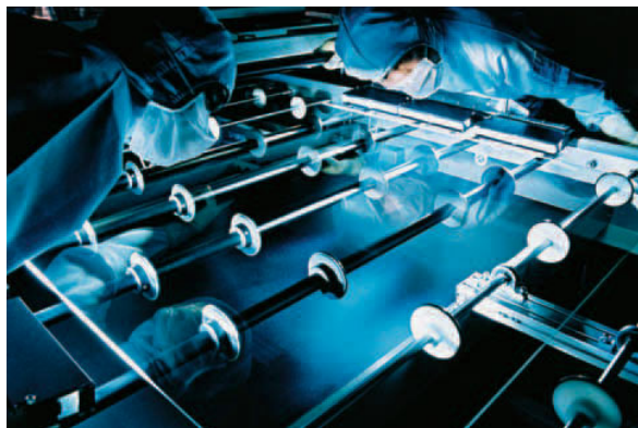
プラズマディスプレイ用ガラスの最終検査風景。0.1mm レベルの気泡や、微小な傷の有無まで、きちんとチェックしている
