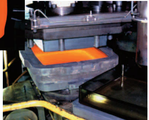
上: 1,600℃で溶解したガラスを1,000℃まで温度を下げ、成型機に供給する 下: 供給されたガラスを、金型を使って加圧成型する
