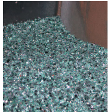
強化ガラスをリサイクルするには、緑の黒い部分と透明部分のカレットを分ける必要がある。そこで分離装置に通して分別していく
