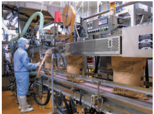
稼働を開始したファイン重曹の製造設備。医薬用を始めとする高品質な重曹を製造できる。原料の苛性ソーダは、国内でも最もエネルギー効率の高い鹿島工場のイオン交換膜法電解プラント製造品を用いるとともに、もう一方の原料である炭酸ガスについても、他工程の副産物を有効活用して製造・精製している
