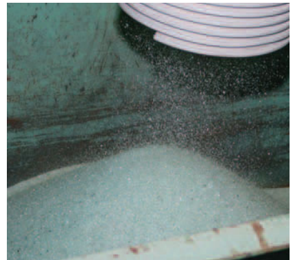
フィルムを除去する際に粉砕されるカレットは、サイズ別に振り分けしていく
