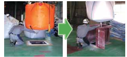
フレコンを吊り上げるときにヒモが切れる 被災の可能性c/ケガの大きさ / リスクレベル10
