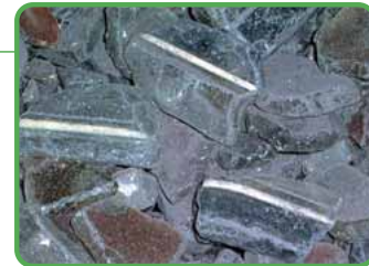
数センチ角の大きさのカレット。ブラウン管のパネル(前面)側とファンネル(後面)側の境目にフリット(接合材)が混入している
