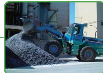
ブラウン管用ガラスのカレットと、他のカレットをブルドーザーで混合して均質化する
