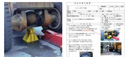
ショベルのタイヤ交換時にジャッキが外れて挟まれる 被災の可能性c/ケガの大きさ / リスクレベル10
