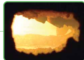
溶融炉の中。カレットは溶解されてブラウン管用ガラスにリサイクルされる
