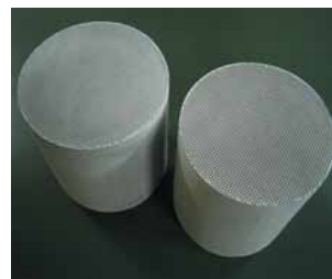
1cm 2 に約40個の穴が空いている窒化珪素フィルター。写真はハニカムと呼ばれる目封じをかぶせた状態
