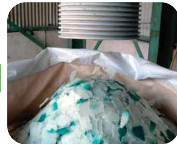
剥離された中間膜のフィルム
