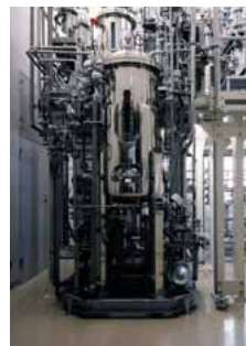
タンパク質製造用300ℓ培養槽
