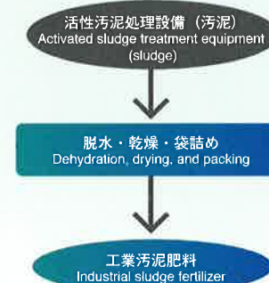
汚泥の再利用フロー図 Sludge reuse flow diagram
