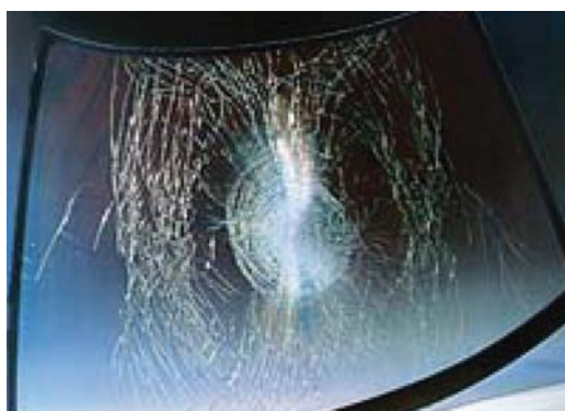
Fig. 1 自動車用合せガラス（破損時）
