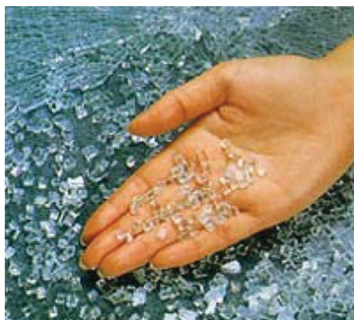
Fig. 2 自動車用強化ガラス（破損時）
