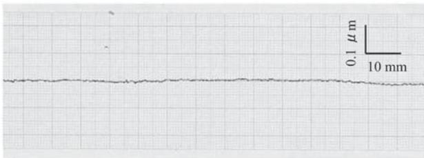
Fig.10 AN100基板の表面プロファイル
