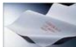
苛性ソーダ製造用 イオン交換膜
