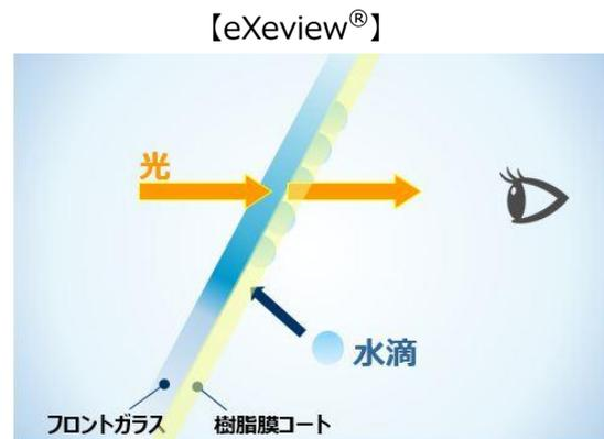
A G C 独自の樹脂膜コートが水滴を吸収することで、結露を防ぎ、前が見える。
