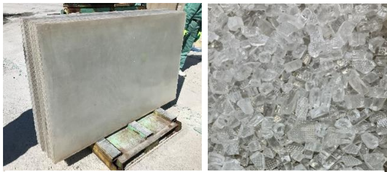
太陽光パネルから板状で回収され、粉碎されたガラス (左写真状態と比べて異物の混入を防ぐことができ品質管理が容易)
