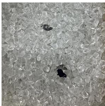
割れた状態で回収された太陽光パネルのカバーガラス (リサイクル前に異物の除去が必要)
