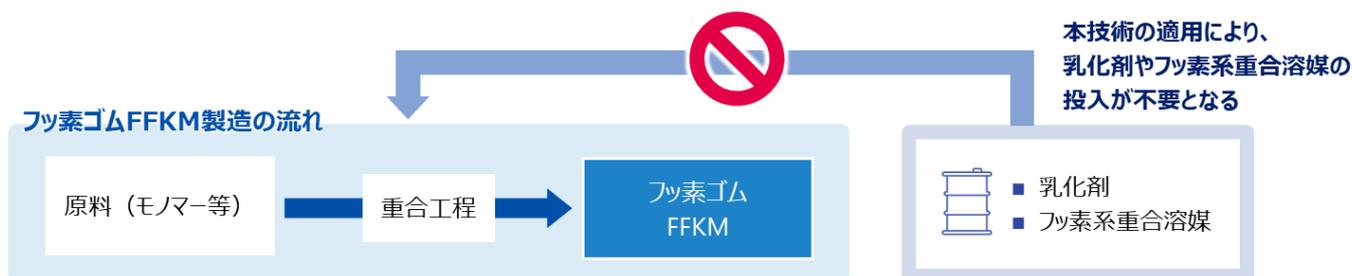
「AFLAS<sup>®</sup> FFKM」は、フッ素ゴムの中でも最高レベルの耐薬品性・耐熱性・耐プラズマ性を持つ産業用ゴムであり、過酷な環境でも劣化しにくい特性を持っています。そのため、半導体製造、石油掘削、ヘルスケアなど、高い耐久性が要求される分野で、シーリング材や<sup>ス</sup>リングとして幅広く使われています。中でも半導体製造工程の一つであるエッチング工程では、高い耐プラズマ性を有する「AFLAS<sup>®</sup> FFKM」が無くてはならない材料として強く支持されています。その劣化しにくい特性からエッチング装置のシーリング材料として使用されており、装置のメンテナンス間隔の大幅な延長および安全性の向上に貢献しています。
