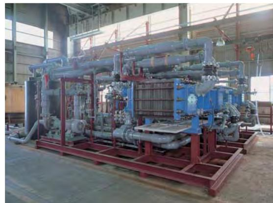
イオン交換膜「セレミオン」を組み込んだ電気透析装置
